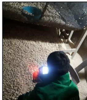
**Foto 2:** medición con XRF sobre suelo de la habitación de cocción de tutucas.
