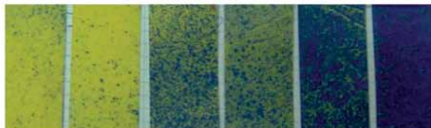
Gráfico 6 - Escala de impactos de gotas en tarjetas hidrosensibles.
